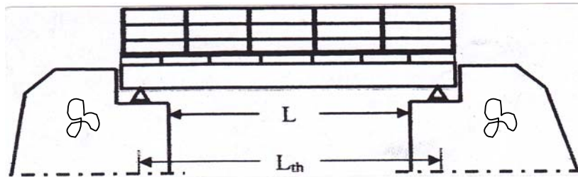
Potongan memanjang jembatan
