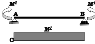
Gambar 6.2 Lentur Murni Balok Sederhana
