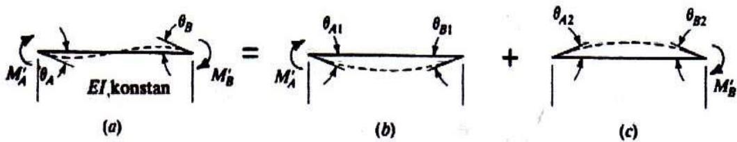
Gambar 3.3 Statika dan Deformasi Batang Terlentur Yang Tak Dibebani
