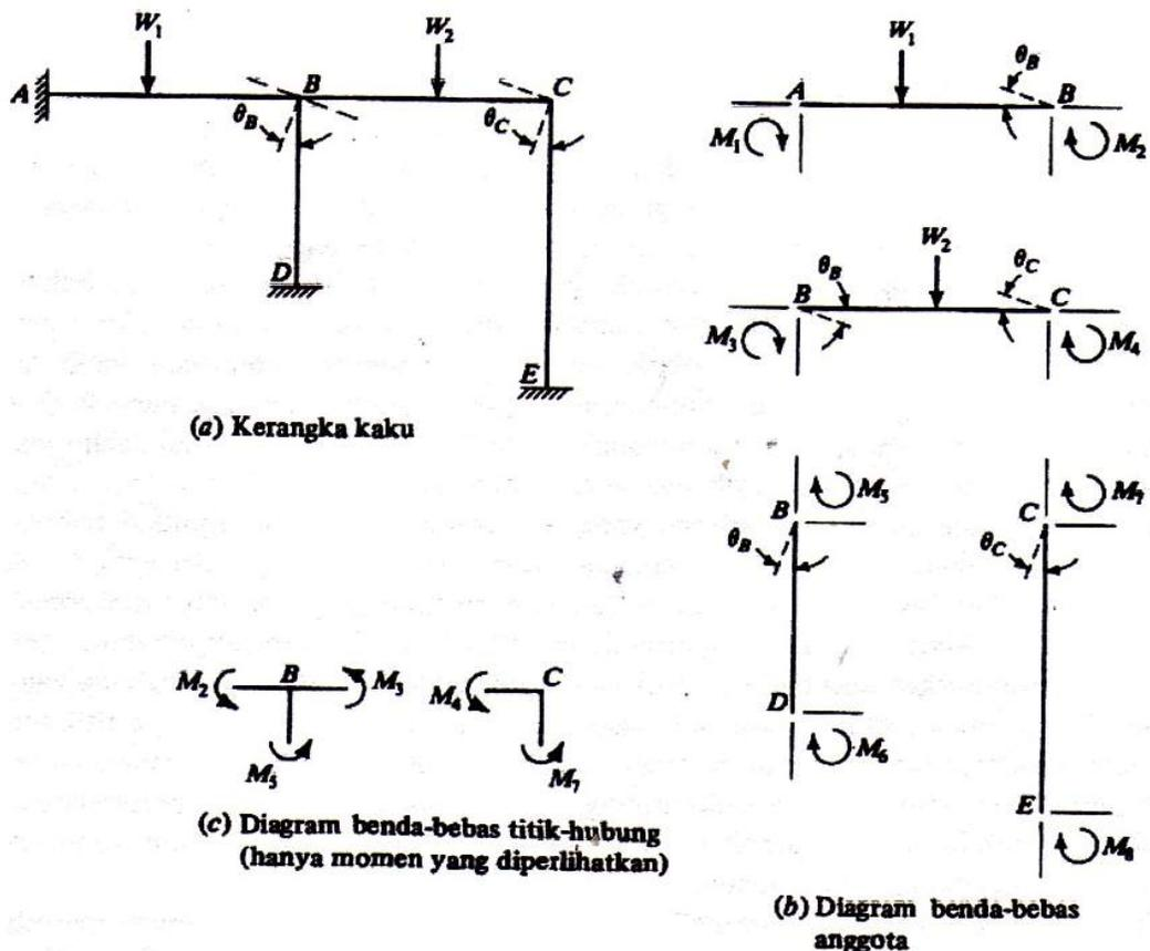
Gambar 3.1 Kerangka Kaku Tipikal Tanpa Translasi Sambungan
