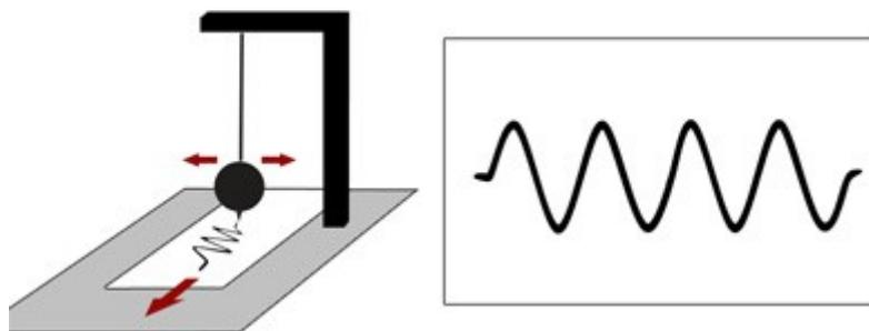
**Gambar Matdis1-1.** Sinyal Kontinyu pada uji pendulum
