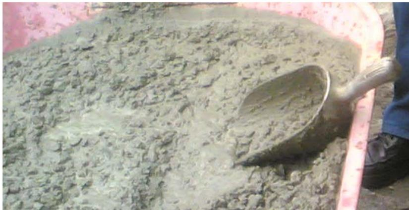
Gambar 1.6.6 Agregat dapat dilihat dan antara agregat terisi penuh dengan pasta dan pasir. Adukan merupakan adukan dengan komposisi pasir yang tepat. Permukaan yang dilicinkan rata tanpa ada rongga-rongga.
