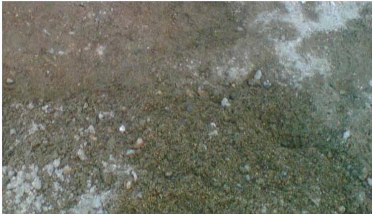
Gambar 1.6.1 : Adukan beton kekurangan agregat halus (pasir). Terdapat rongga-rongga pada adukan (honeycombing), karena tidak cukupnya pasta dan pasir mengisi rongga tersebut. Segregasi (berderainya unsur adukan) juga merupakan indikasi kurang adanya ikatan yang terjadi antara bahan-bahan
