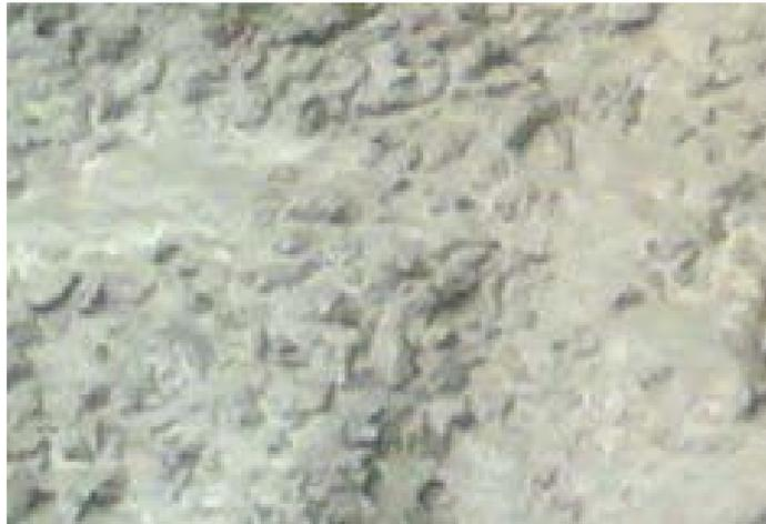
Gambar 1.6.4 Adukan gemuk. Agregat kasar lenyap dari permukaan yang dilicinkan.
