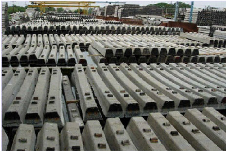
Gambar 2.27 Proses Perawatan Beton pada bantalan rel menggunakan air
