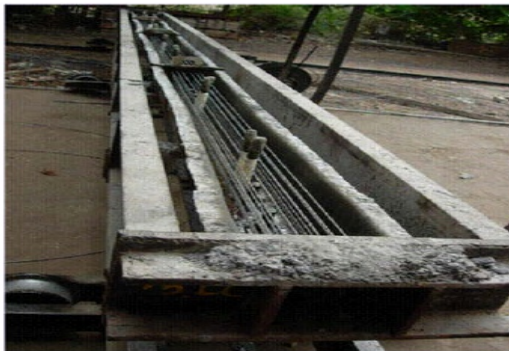
Gambar 2.16. Pengangkuran strands. Bajak dan silinder dipasang pada ujung tetap
