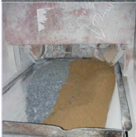
Gambar 2.20. Penakaran dan pencampuran material dengan perbandingan berat
